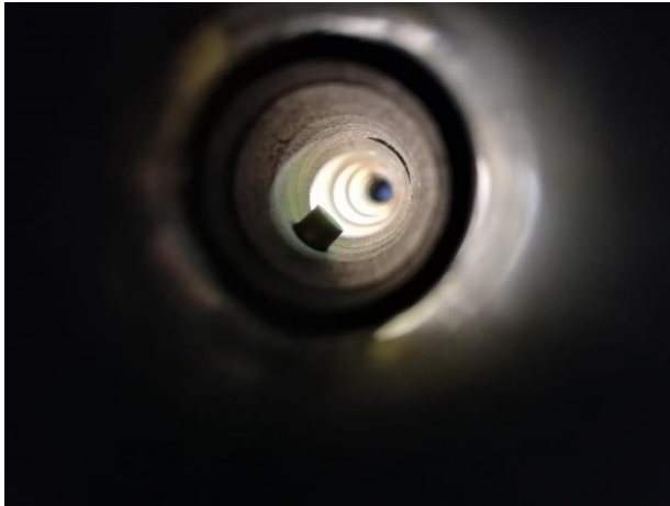
Figure 6 : Excroissance de la bague (Buchse) du trou du pouce à l'intérieur de la perce du csakan.
